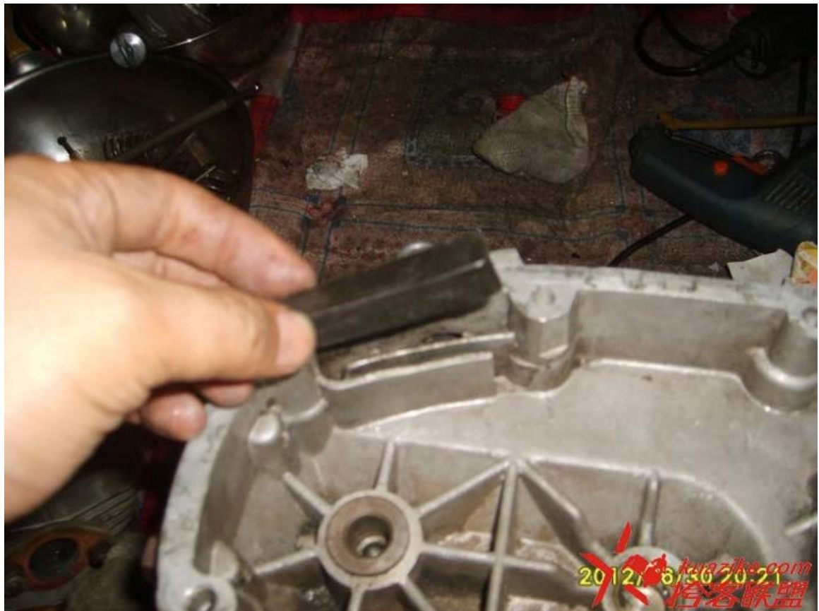
装上前机盖上的废气阀的橡胶封堵，要求不能太松，否则掉下来会咬坏正时齿轮，并影响废气油气分离。
