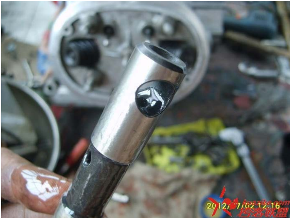
摇臂轴分上下，上部有一个孔，呈空心状，内部需要预先灌入机油。
