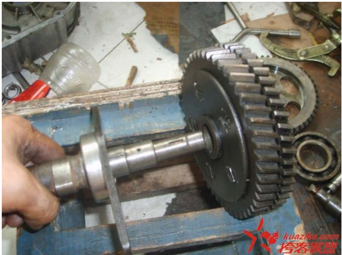
装入凸轮轴固定压板和定位键后压入超越离合器，可能会需要用压床才可以。 Assembling the camshaft components.
