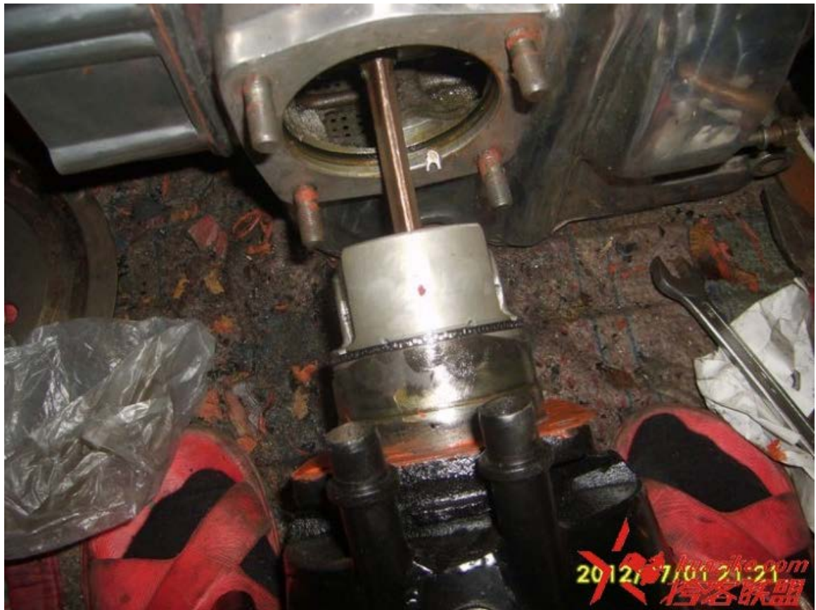
装上曲轴箱气缸孔内的橡胶密封圈，并在密封圈上抹上黄油，方便气缸尾部顺利进入。 Grease the O-rings.
