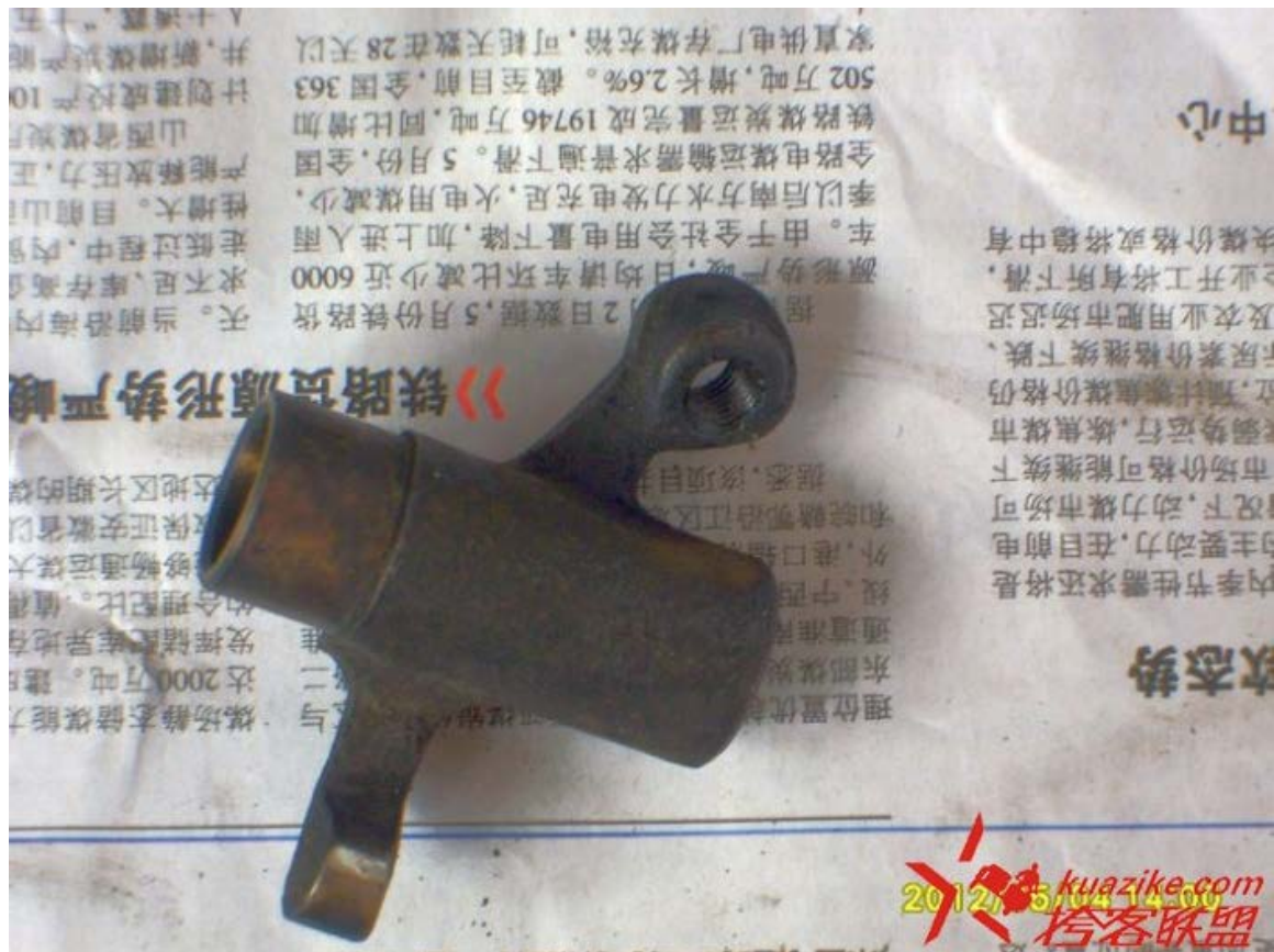
原厂的摇臂 The original rocker arm.
