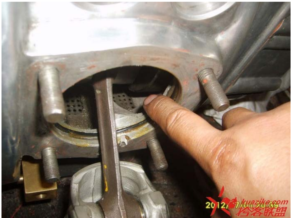
装上曲轴箱气缸孔内的橡胶密封圈，并在密封圈上抹上黄油，方便气缸尾部顺利进入。 Grease the O-rings.
