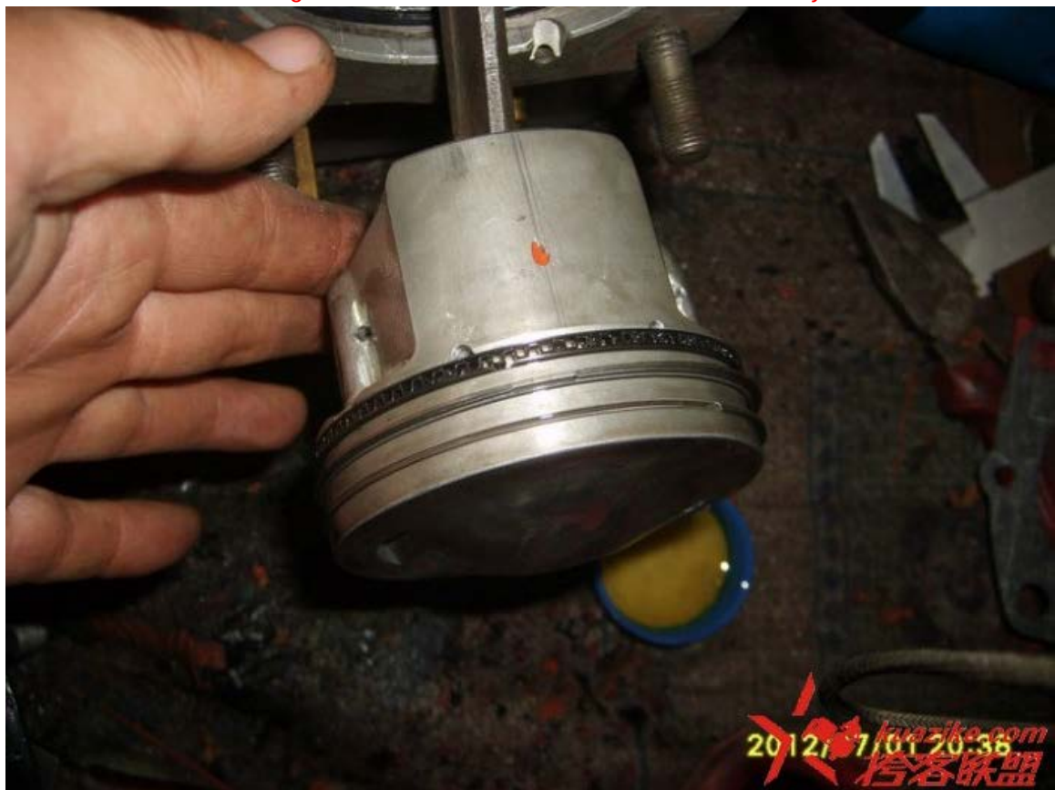
环口三道环各自相差120度，组合油环的两道相差180度，各个环口都需要避开活塞销孔位置。
