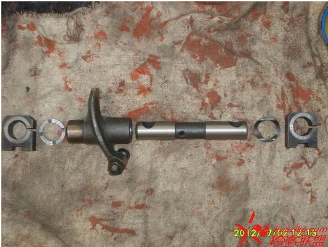
气门摇臂的组合顺序，从下到上依次是，下固定脚，摇臂垫，摇臂，摇臂轴，波形垫，上固定脚。 摇臂垫和波形垫都不能有明显的磨损，否则会加大噪音！
